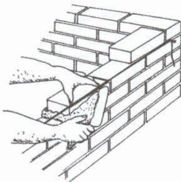
Figura 8 - Retirada do excesso de argamassa
